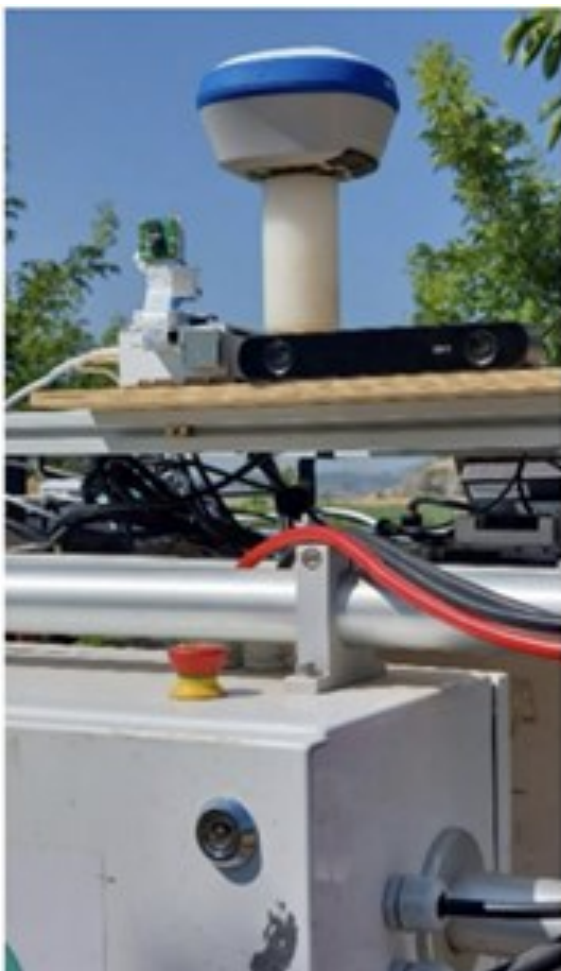
Σύστημα ανίχνευσης ασθενειών στα αμπέλια με τη χρήση UGV.
