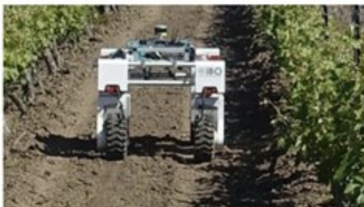
Σύστημα ανίχνευσης ασθενειών στα αμπέλια με τη χρήση UGV.
